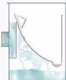
FIAP Spalt Active: Feinfiltration bis 200 µ FIAP wedge wire screen filter: fine filtration up to 200 µ
